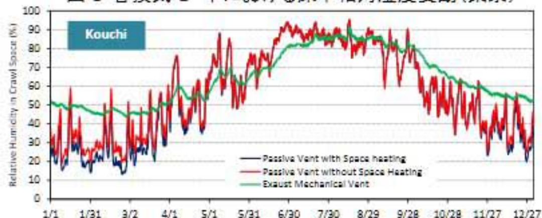
図5 各換気モードにおける床下相対湿度変動(高知)
